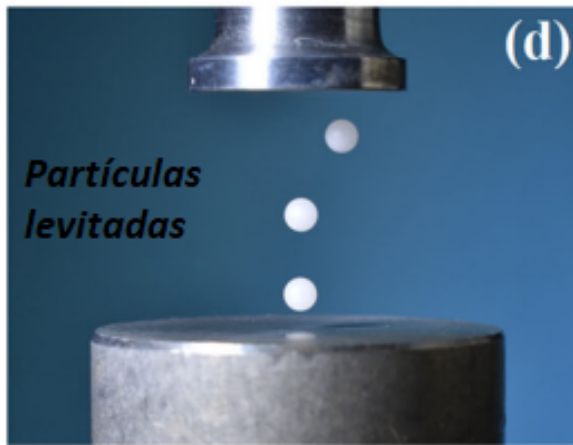
((a)) Levitación de partículas en aire haciendo uso de campos acústicos estacionarios
