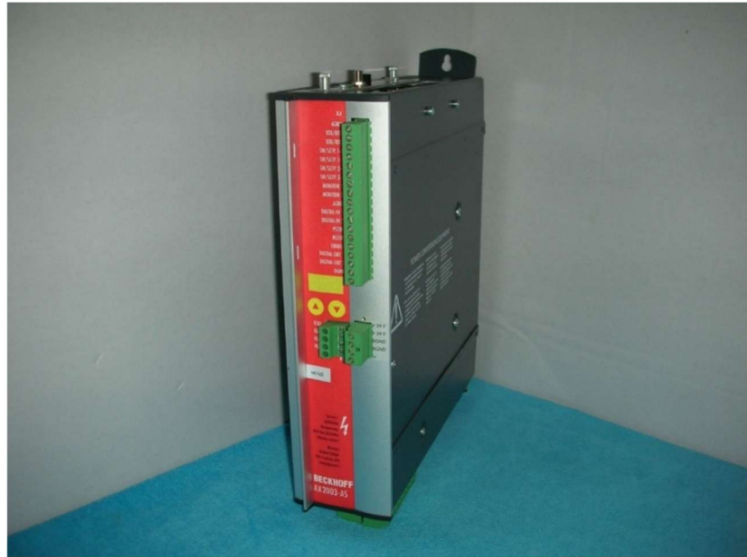
Figura 10. Servoamplificador Beckhoff AX2003-AS. Fuente: eBay, anuncio "BECKHOFF AX2003-AS S60301-520" [en línea]. Disponible en: https://www.ebay.com/itm/255952947520 (Consultado el 27 de septiembre de 2025). Uso académico y sin fines comerciales.
