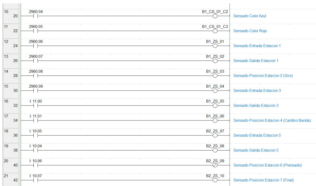
Figura 34. Mapeo de Entradas Parte 2. Fuente: Elaboración propia, 2025.
