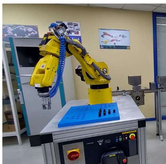
Figura 9. Robot FANUC M6iB 6S de 6 grados de libertad (GDL) con controladora FANUC R-J3C. Fuente: Elaboración propia, 2025.
