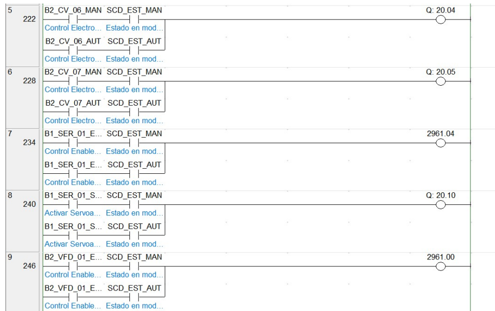
Figura 39. Mapeo de Salidas Parte 2. Fuente: Elaboración propia, 2025.
