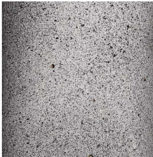
Figura 23: Patrón de puntos aplicado con aerosol
