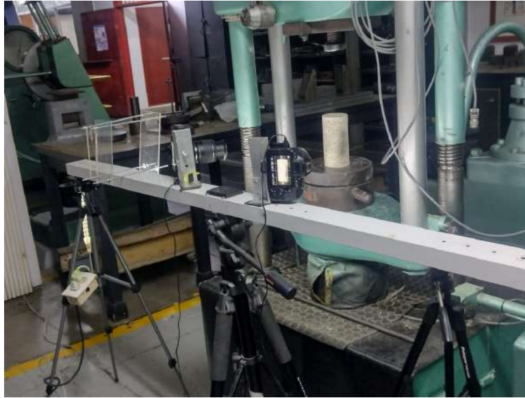
Figura 27: Montaje de soporte para las camaras del DIC. Fuente: Elaboración propia
