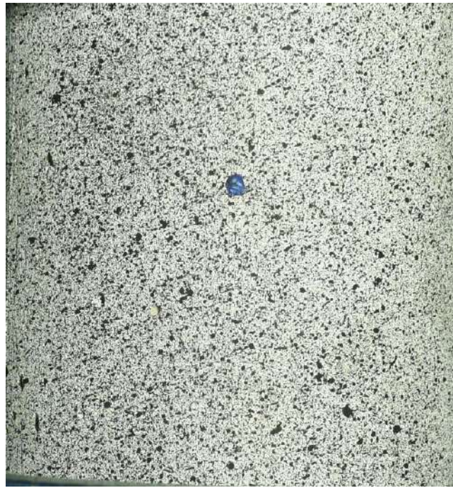
Figura 24: Patrón de puntos aplicado con pistola de aire
