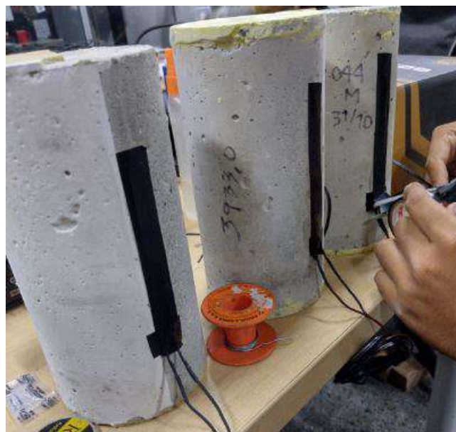
Figura 22: Instrumentación del cilindro con galga extensiométrica para concreto
