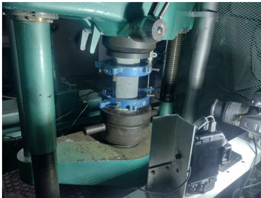
Figura 26: Montaje de muestra cilíndrica en máquina universal. Fuente: Elaboración propia
