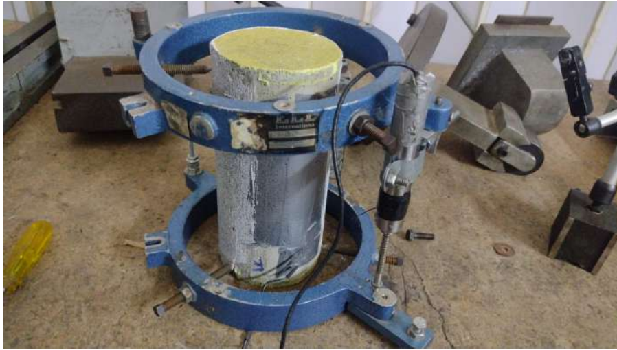
Figura 25: Anillos de soporte para compresometro tipo LVDT
