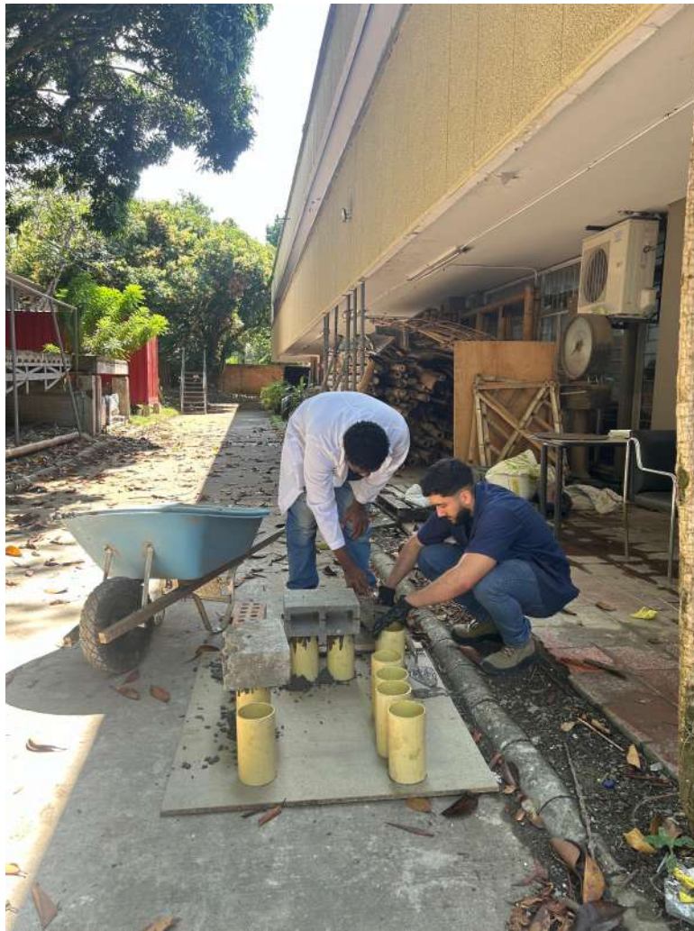
Figura 18: Preparación de muestras cilíndricas de concreto. Fuente: Elaboración propia.
