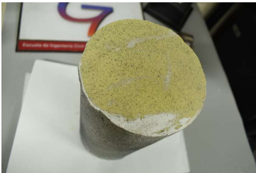
Figura 20: Capinado de muestras cilíndricas de concreto. Fuente: Elaboración propia.
