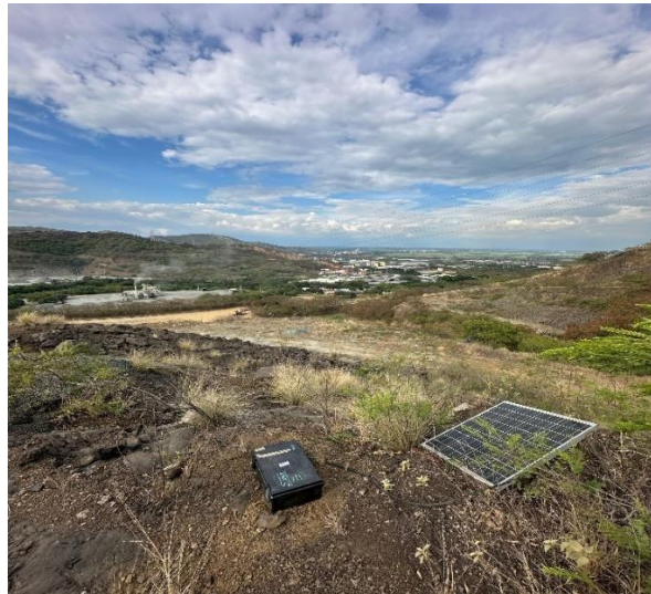
Figura 30-Sismógrafo instalado in situ cantera Pera y Cia SAS. Fuente: Los autores
