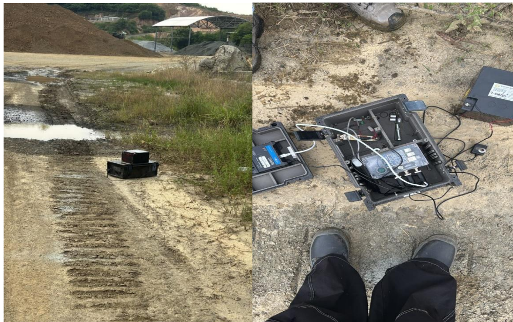
Figura 20- Sismógrafo instalado in situ cantera Pera y Cia SAS. Fuente: Los autores
