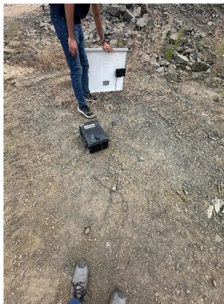
Figura 26- Sismógrafo instalado in situ cantera Pera y Cia SAS. Fuente: Los autores
