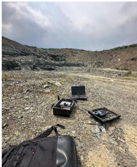
Figura 22- Sismógrafo instalado in situ cantera LA ROCA. Fuente: Los autores
