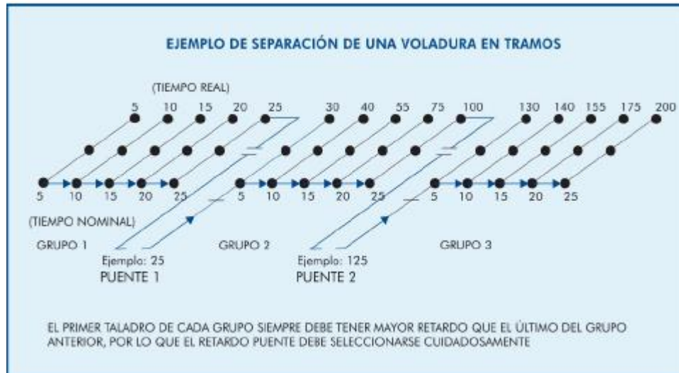
Figura 8. Ejemplo distribución de una voladura en tramos. Fuente: EXSA S.A
