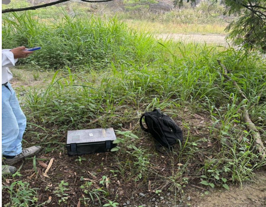
Fotografía 4. Instalación del sismógrafo en la voladura 13/05/25, empresa Perea S.A.S., cantera Arroyo hondo.
