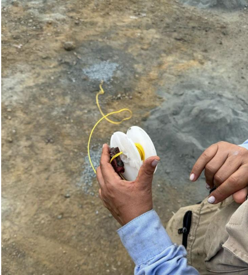
Fotografía 9. Detonador electrónico usado en la voladura 29/07/25, empresa Perea S.A.S, cantera Guabinas.
