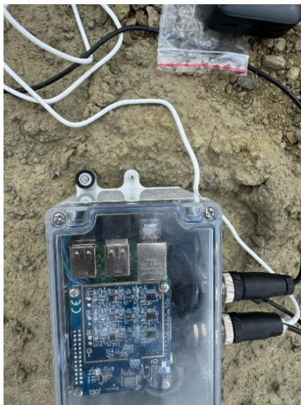
Figura 18- Sismógrafo instalado in situ cantera Pera y Cia SAS. Fuente: Los autores
