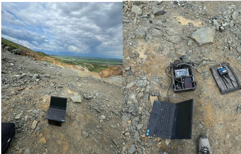
Figura 24-Sismógrafo instalado in situ cantera MATERIALES Y AGREGADOS EMT SAS. Fuente: Los autores
