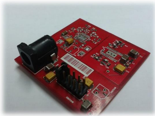
Figura 6.31 Placa de prueba de fuente de alimentación 3.3V/1.8V defectuosa
