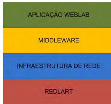
Figura 2.10 Arquitectura propuesta para aplicaciones de Laboratorio Remoto basado en REDLART [47]
