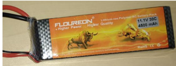
Figura 4.6: Batería LiPo 4500mAh 30C
