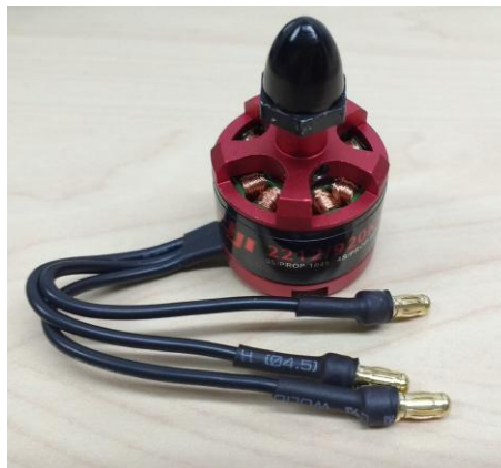
Figura 4.4: Motor Brushless 2212 de 920 KV
