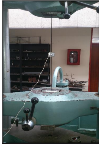
Foto 3. Prueba estática dinámica de alambre de tensionamiento L=580 mm.
