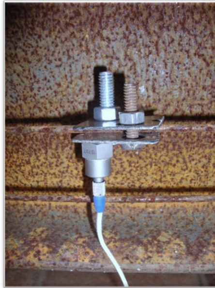
Foto 4. Ensamble de acelerómetro al alambre de tensionamiento.
