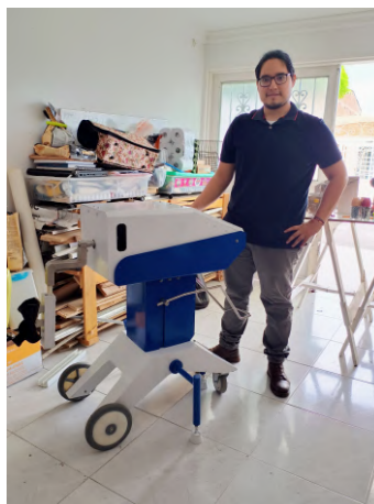
Figura 6.72: Conjunto ensamblado de la propuesta de evolución de la carcasa del Proyecto ALFI y la propuesta de mejora del conjunto actuador.
