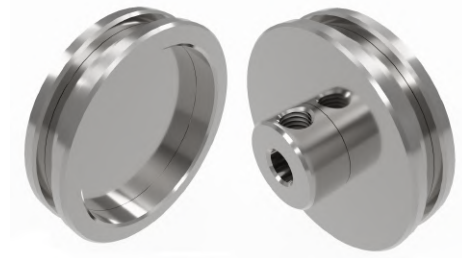
Figura 4.43: Representación en software AutoDesk Inventor de la rueda diseñada para medir el movimiento angular del eje de salida acoplándose al encoder.
