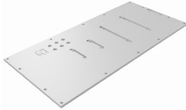
Figura 4.37: Representación en software AutoDesk Inventor de la placa base diseñada para el montaje de los soportes y componentes de la ayuda técnica multifuncional teleoperada.
