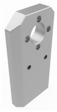
Figura 4.32: Representación en software AutoDesk Inventor del soporte diseñado para el conjunto motor.
