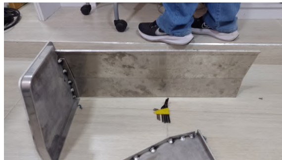
(b) Tapa lateral y posterior de la carcasa
