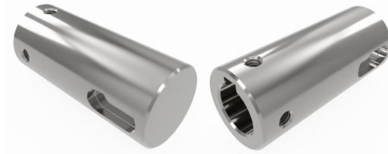
Figura 4.40: Representación en software AutoDesk Inventor del acople diseñado para conectar el eje de salida del motor al acople flexible.
