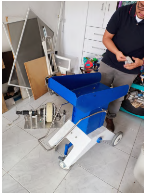
(a) Preparación de la carcasa y el conjunto actuador
