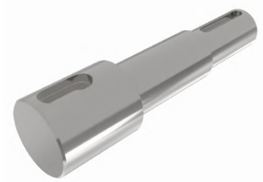
Figura 4.38: Representación en software AutoDesk Inventor del eje diseñado para transmitir movimiento desde la salida del conjunto motor hasta la primera etapa del clutch.
