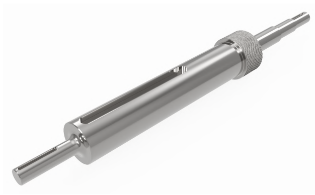
Figura 4.39: Representación en software AutoDesk Inventor del eje diseñado para transmitir movimiento desde la segunda etapa del clutch y a través del freno magnético.
