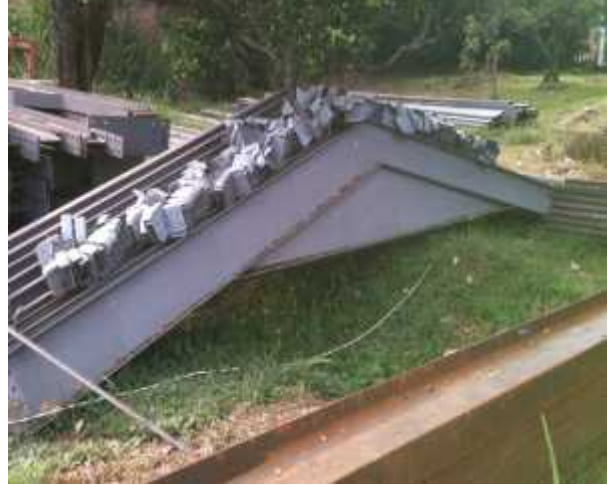
Ilustración 6 producto terminado cubierta metálica para bodega puro Colombia.
