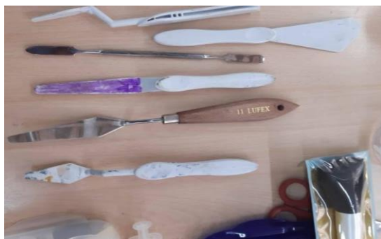
Foto 11: Anny Paola Bustamante, año 2020, Diferentes tipos de espátulas empleadas para el retiro de adhesivos y pegamento en los positivos.
