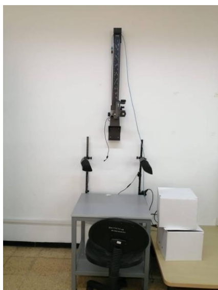
Foto 4: Alfredo Flores, año 2020, Sistema de cámara por el cual se logra la digitalización de periódicos y libros antiguos
