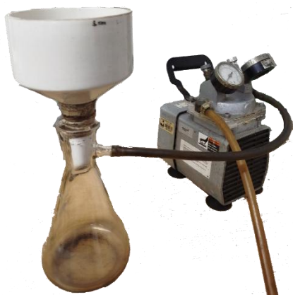
Figura 13. Sistema para el filtrado de hidrocarbonizados
