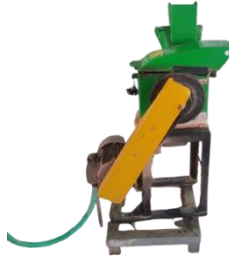
Figura 7. Molino forrajero de martillo de biomasa utilizado.
