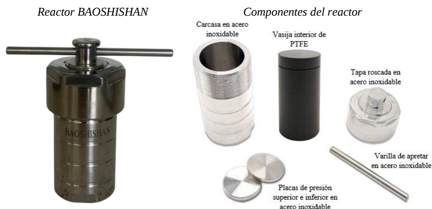
Figura 9. Reactor HTC y piezas que lo componen
