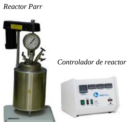
Figura 15. Reactor Parr utilizado, fuente: (Camacho Daza & Valencia García, 2024)
