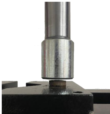
Figura 18. Ejemplificación de briqueta sometida a carga en prensa hidráulica manual.
