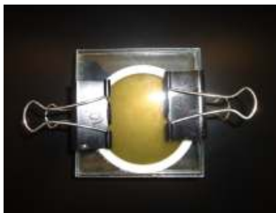
Figura 12. Dispositivo empleado para la síntesis de los hidrogeles.
