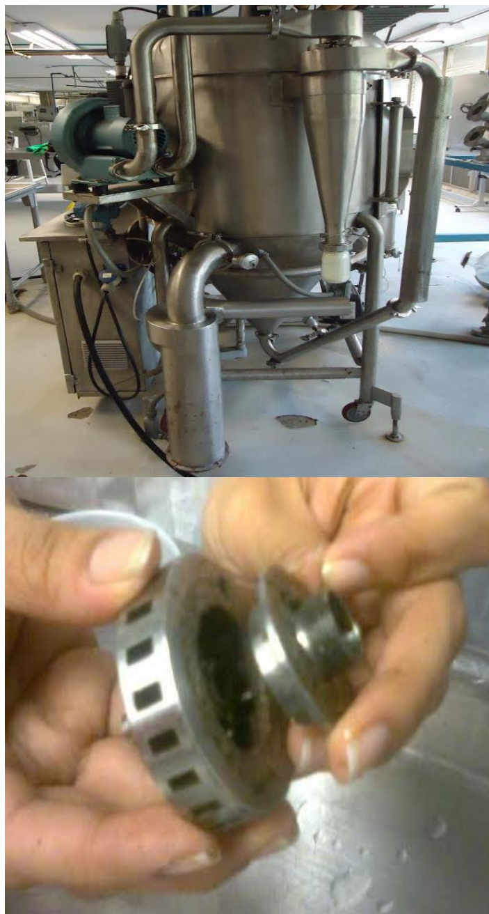
Figura 22. (Arriba) secador por aspersión. (Abajo) atomizador de disco centrífugo.
