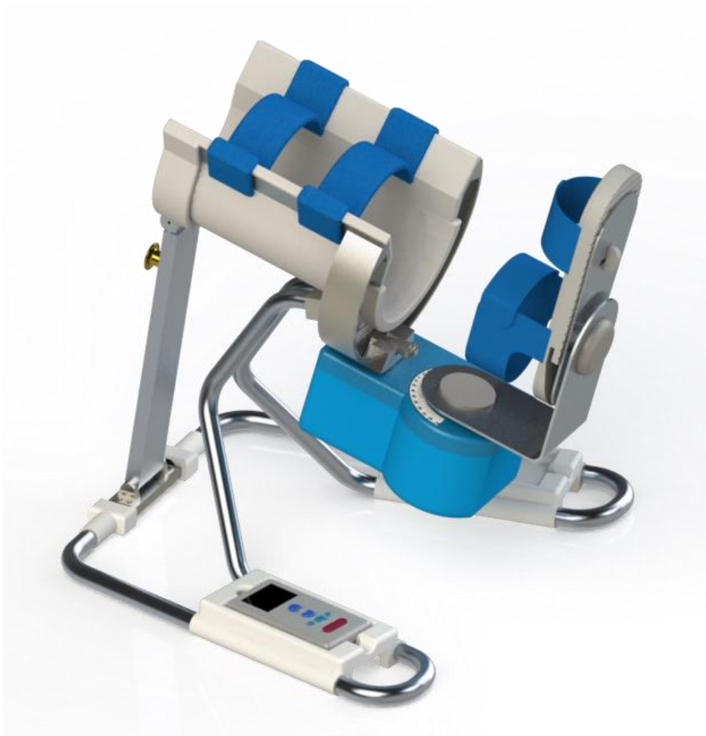
Figura 28. Representación del dispositivo de rehabilitación física para la articulación de tobillo diseñado.
