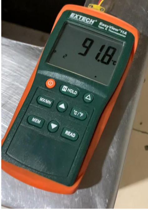
(a) Termómetro Extech Easyview 11A (b) Termopar tipo K. Fuente: Google imágenes, 2025, Disponible en: https://images.app.goo.gl/KoemkAiP3QbrHbHc8
