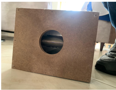
(b) Entrada de aire al ducto
