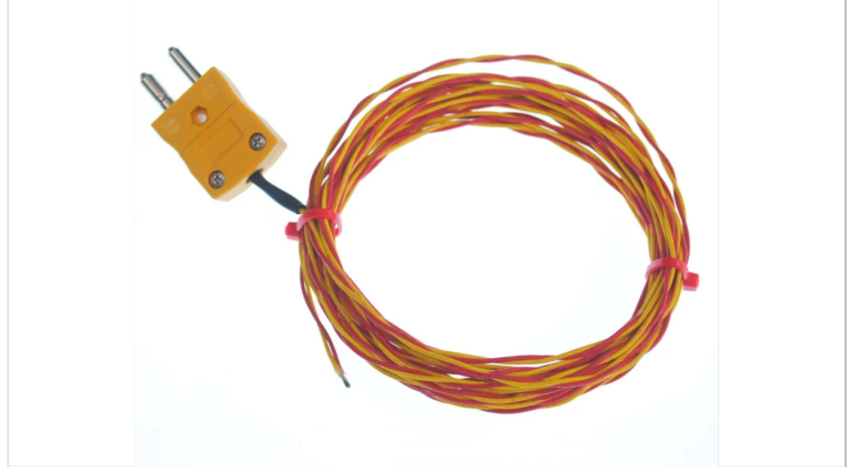
(a) Termómetro Extech Easyview 11A (b) Termopar tipo K. Fuente: Google imágenes, 2025, Disponible en: https://images.app.goo.gl/KoemkAiP3QbrHbHc8
