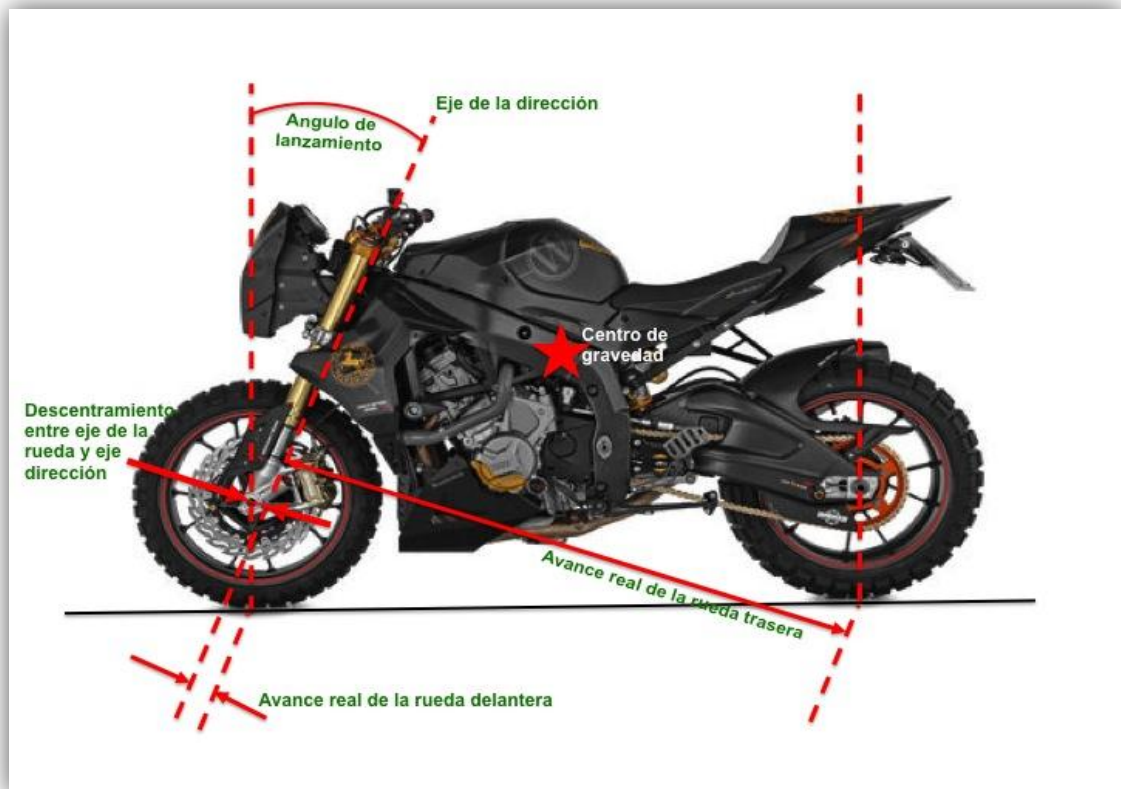
Figura 14. Geometría de una Motocicleta
