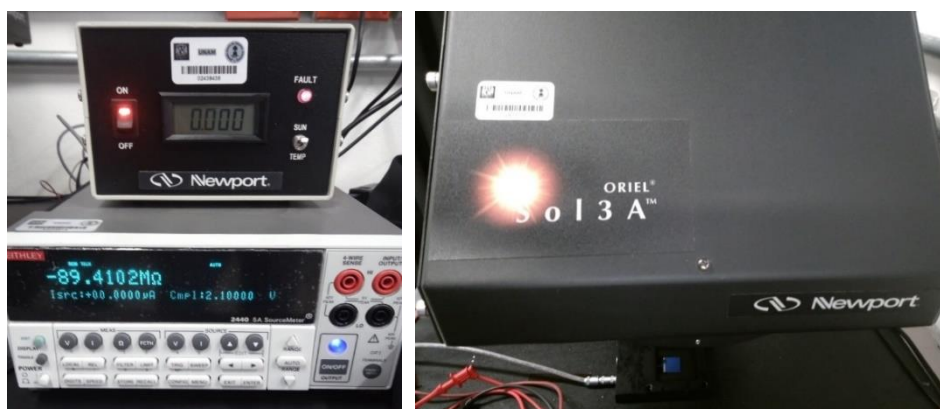
Figura 21. Medidor de fuente digital Keithley (izq.) y simulador solar Newport (der.), empleados para medir las curvas J-V de las celdas.
