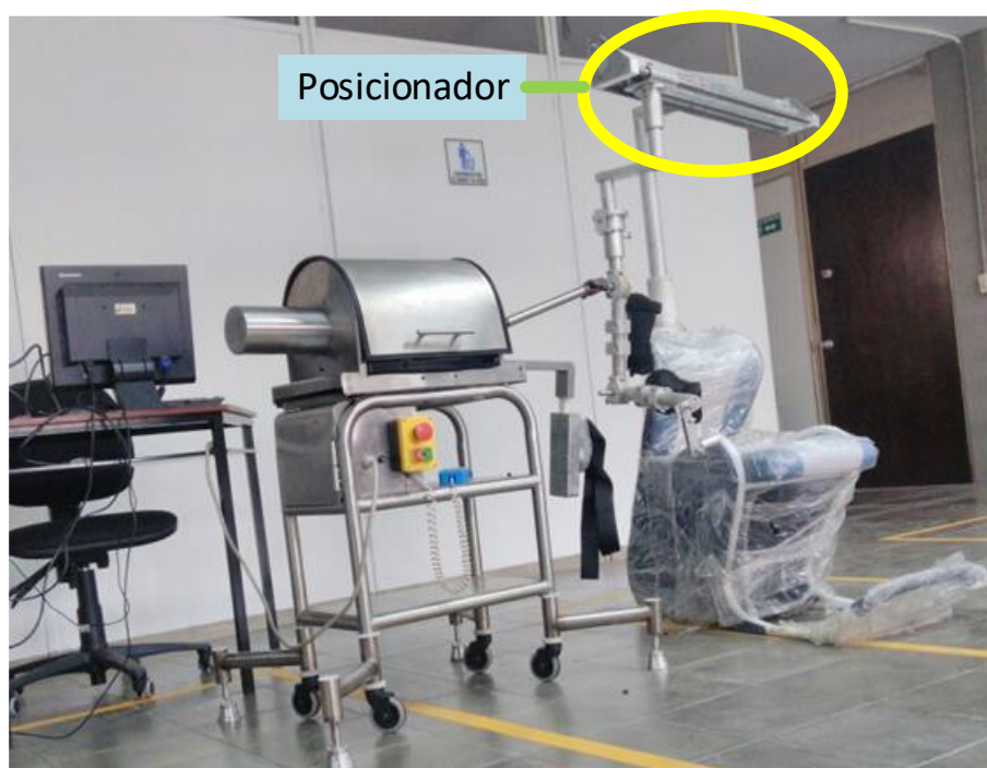
Figura 94. Integración del sistema de rehabilitación tele-operado
