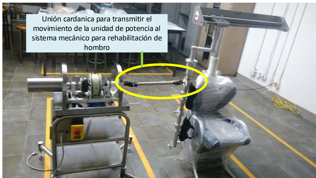
Figura 93. Unión cardanica para la transmisión de potencia
