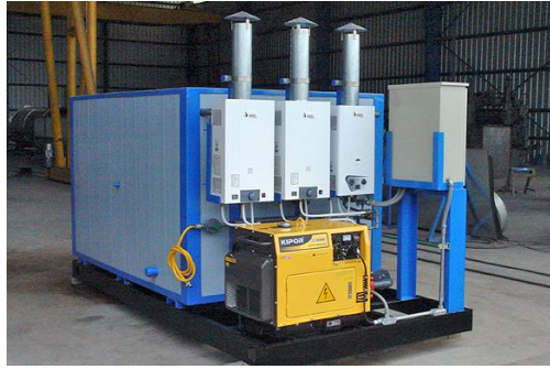
Figura 11 Equipo de tratamiento térmico
