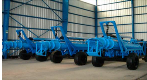
Figura 4 Equipo de bombeo móvil
