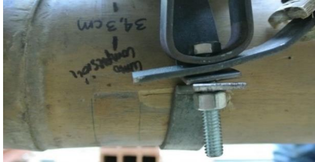
Figura 3-19 Falla de la estructura en la unión. Deslizamiento de la abrazadera tras la aplicación de la carga.
