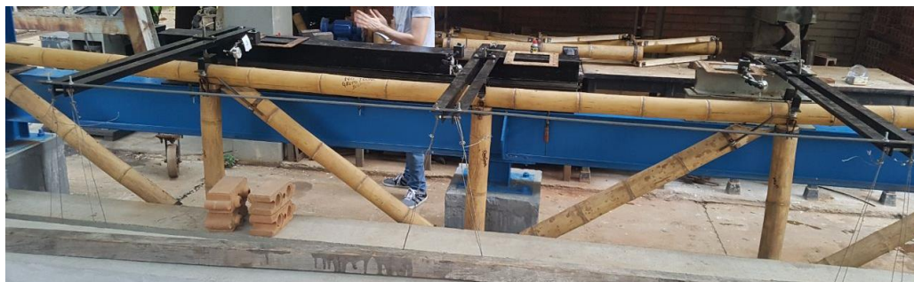
Figura 4-7 Estructura en guadua ubicada y trabajando durante prueba de carga.
