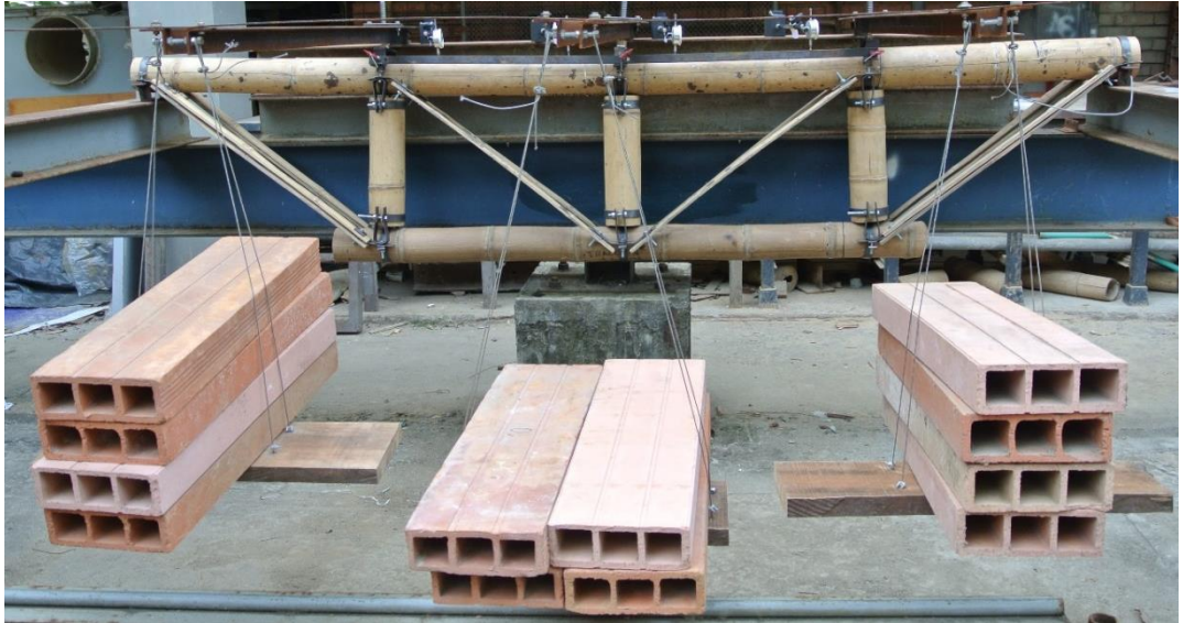
Figura 3-17 Primera cercha de guadua durante la prueba, en el séptimo escalón de carga.
