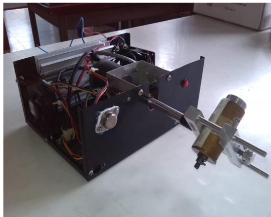
Figura 20. Montaje electro-mecánico, diseñado para tener control sobre los ángulos de elevación del telescopio.
