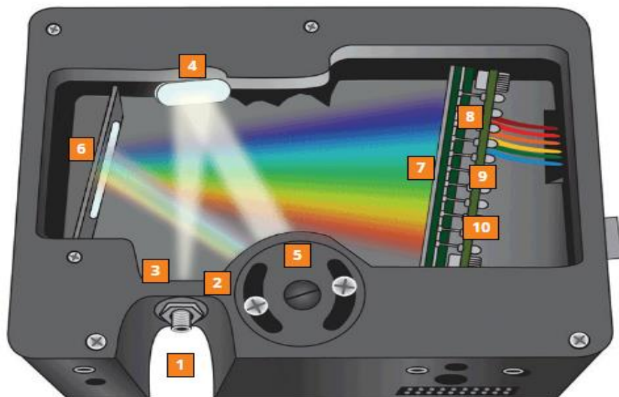
Figura 17. Principales componentes del espectrómetro USB4000 de la firma Ocean Optics. 1) Conector para la fibra. 2) Apertura de entrada de 25 \mu\text{m} . 3) Filtro Óptico. 4) espejo colimador. 5) Rejilla de difracción. 6) espejo de enfoque. 7) lente cilíndrica. 8) Detector. 9) y 10) Filtros para mejorar el rendimiento del espectrómetro. Tomado de (Ocean Optics, 1989-2017)
