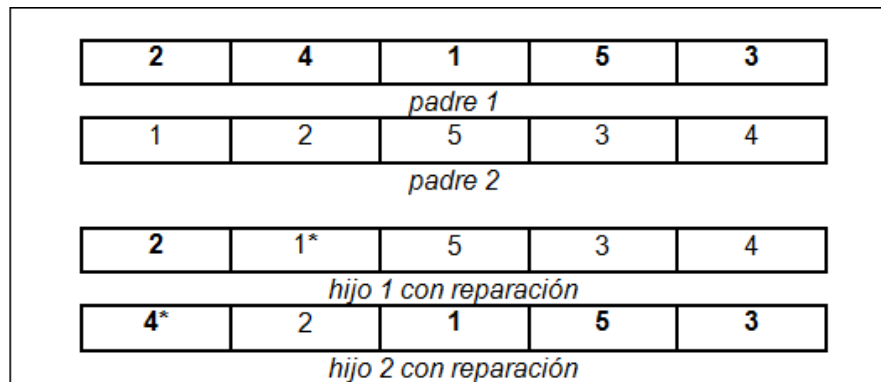
Figura 28 Ejemplo cruce con reparación para Ubicación Total
