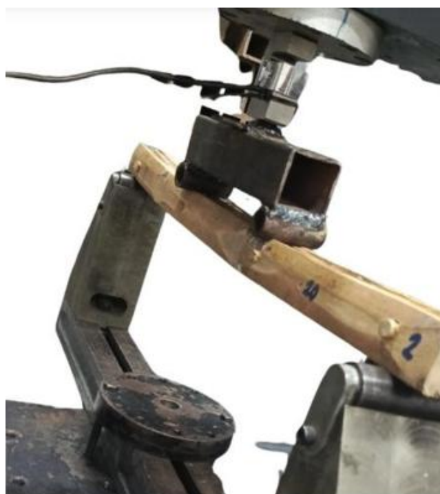
Ilustración 28 Fallas típicas para probetas con espaciado de 150mm.
