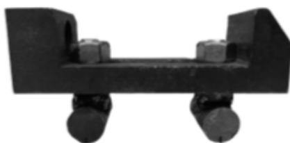
Ilustración 38 Dispositivo de aplicación de carga caracterización mecánica del bambú.
