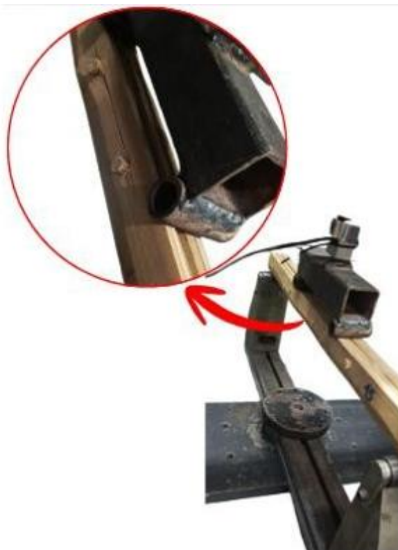
Ilustración 28 Fallas típicas para probetas con espaciado de 150mm.
