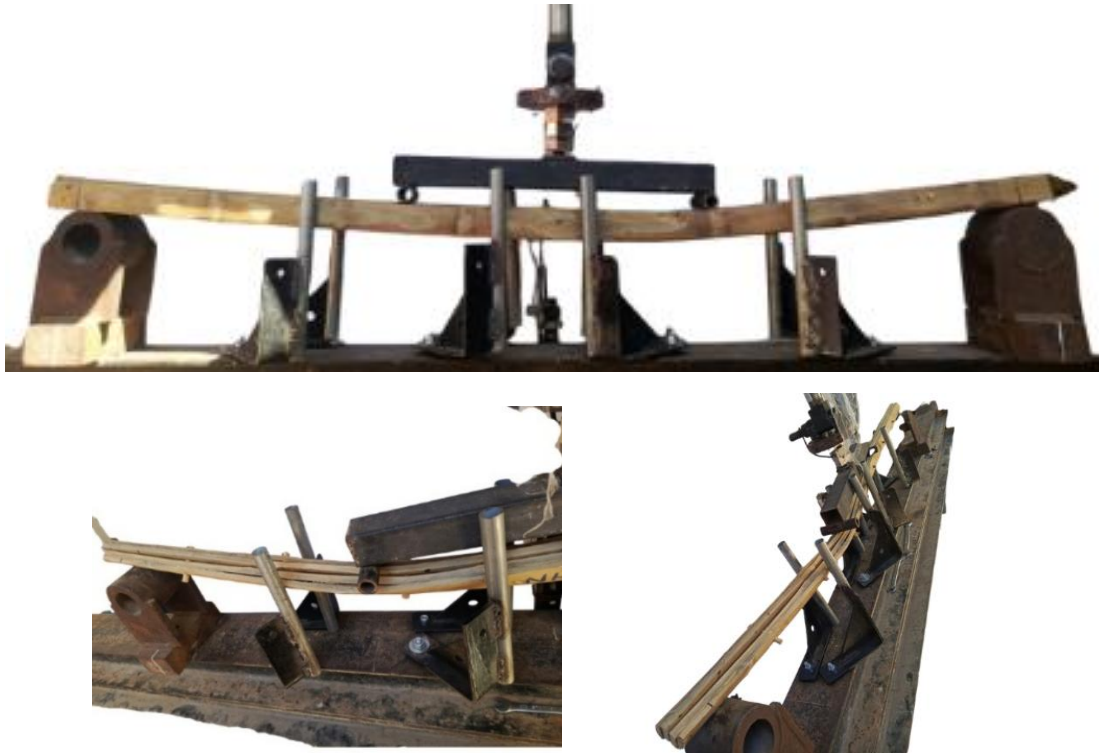
Ilustración 33 Montaje y falla típica en las probetas de 4 latas
