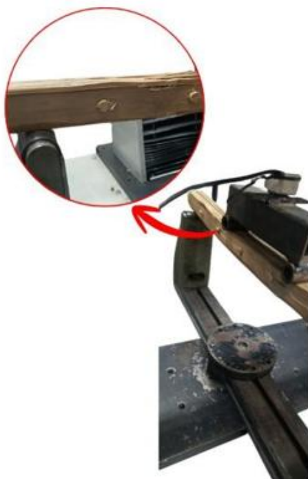
Ilustración 27 Fallas típicas para probetas con espaciamiento de 100mm.
