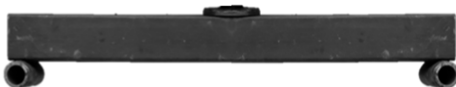
Ilustración 40 Dispositivo de aplicación de carga prototipos finales.
