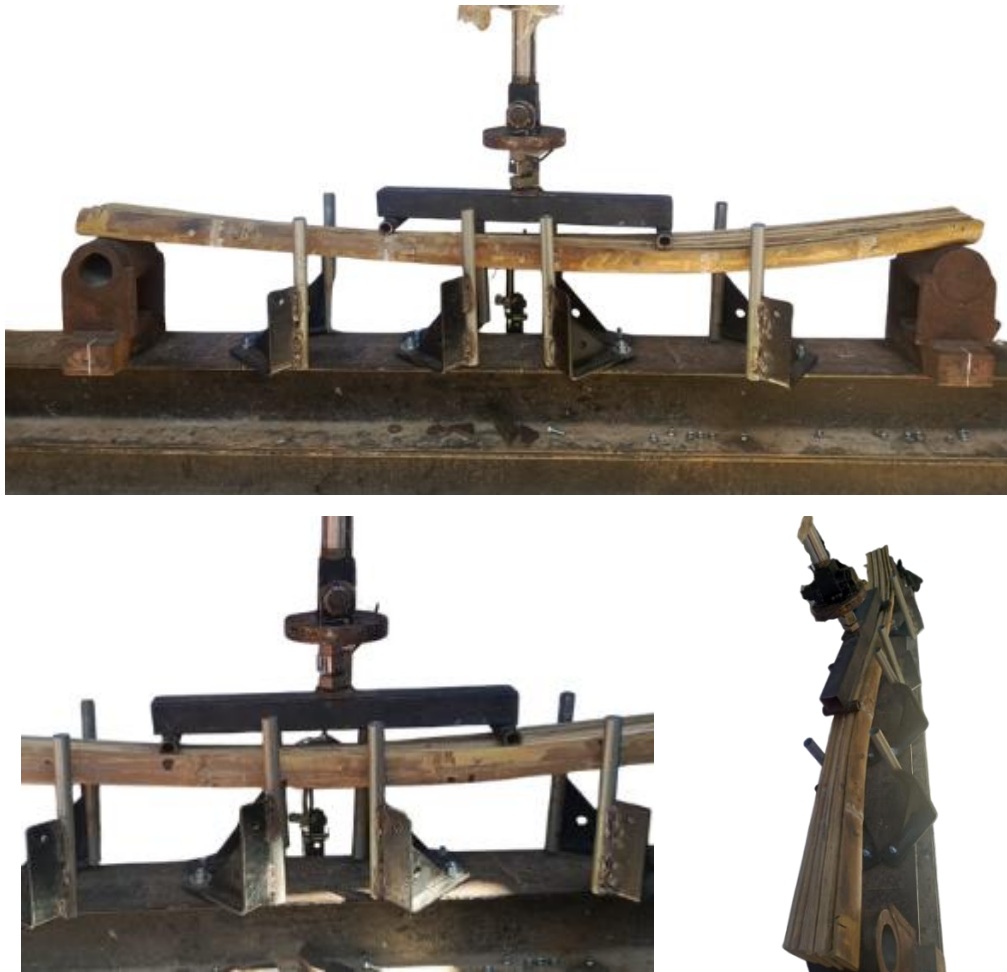
Ilustración 34 Montaje y falla típica en las probetas de 8 latas.
