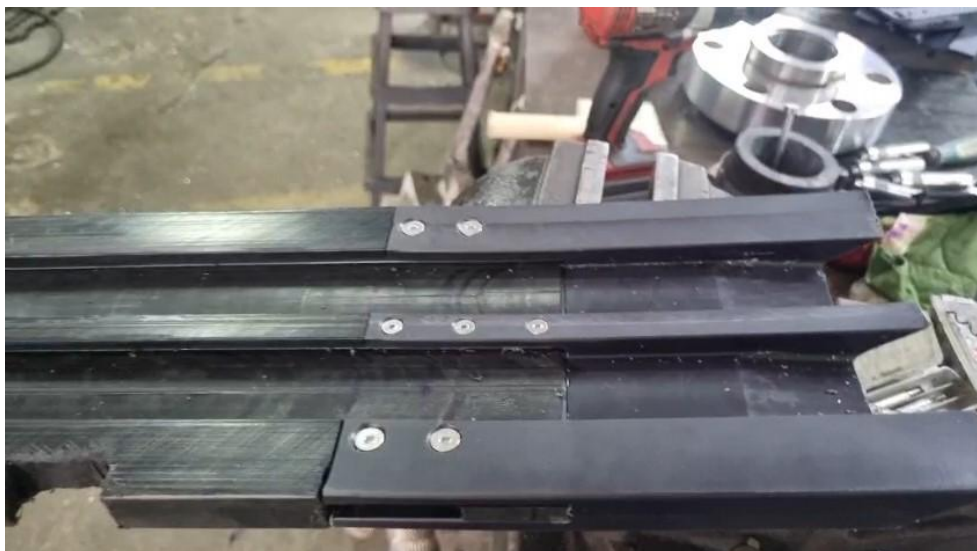
Figura 11: Producto final reparación en caucho.
