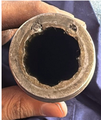
Figura 11: Bujé interno con desgaste en cara hexagonal. [Autor]
