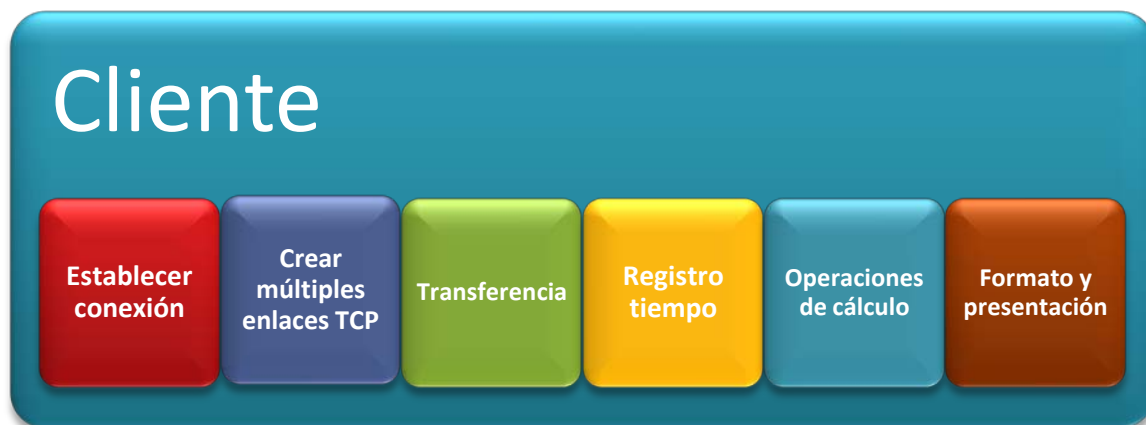
Figura 7 Bloques de las funciones principales del modulo cliente
