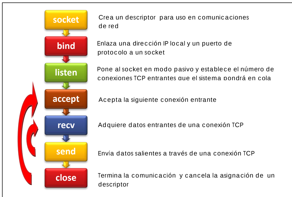
Figura 2 Secuencia de llamadas del sistema de sockets hechas por el servidor usando TCP
