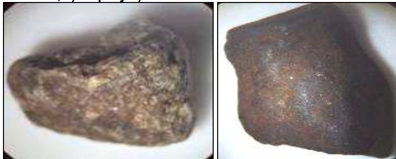
Foto 5. Grava 1/4" - 1/8", a) limpia y b) sucia
