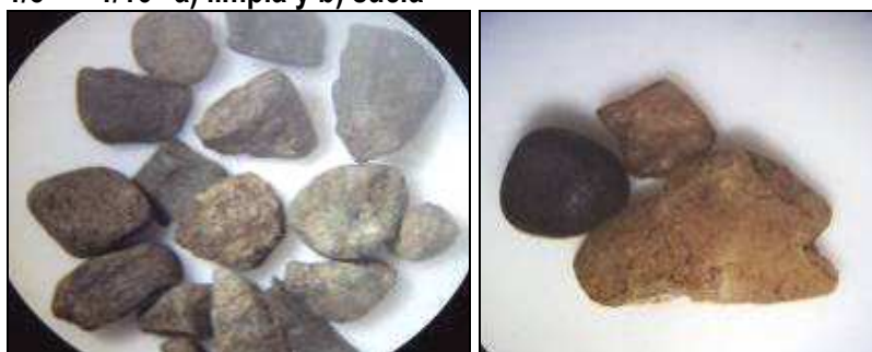
Foto 6. Grava 1/8" - 1/16" a) limpia y b) sucia
