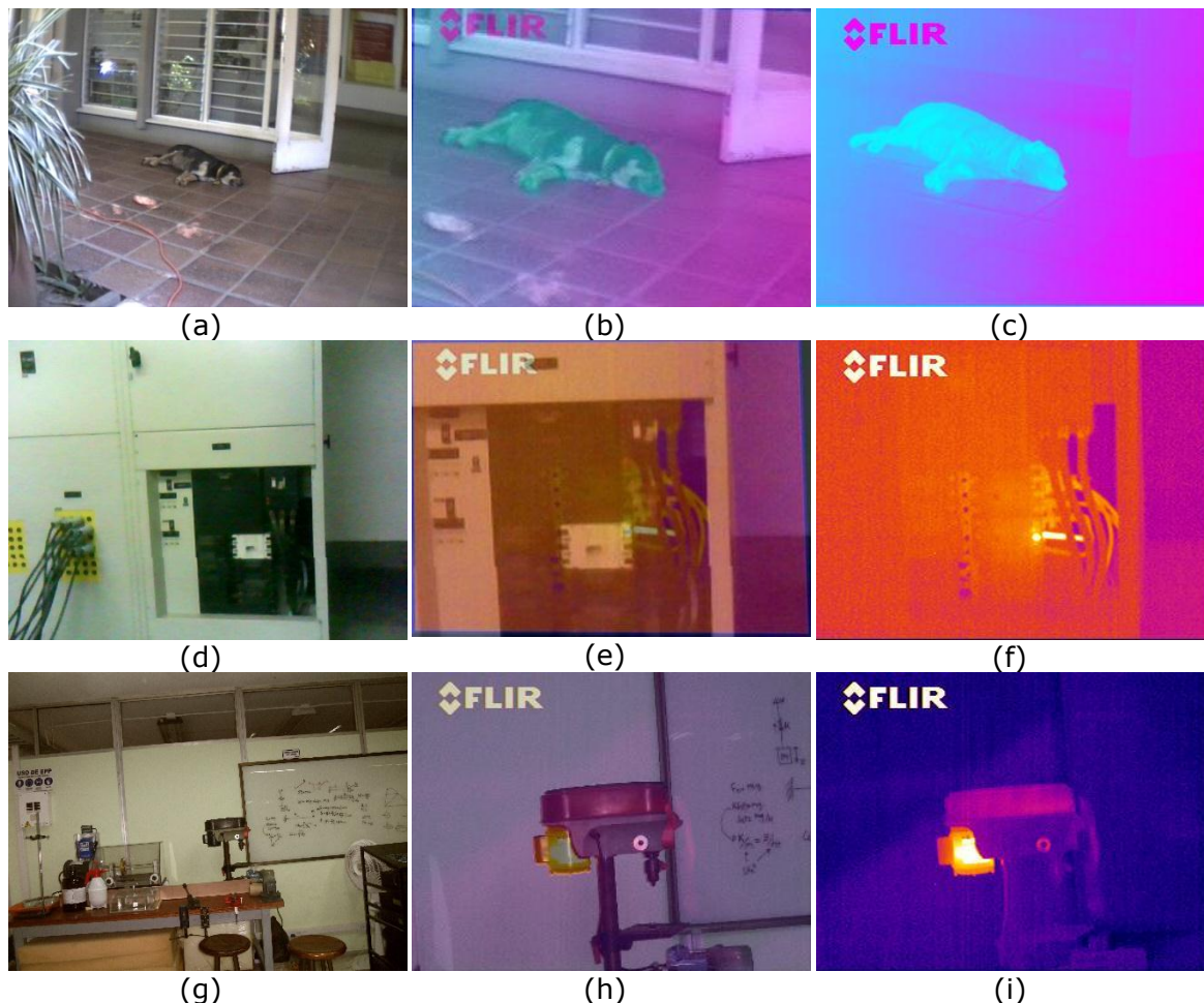
Figura 4.4 Ejemplos de fusión para tres configuraciones de cámaras: Configuración Flir E320 con Sharp: (a) Imagen perro. (b) Fusión térmica 50%IR (c) Termograma perro en paleta Cool . Configuración Flir E320 con webcam Genius: (d) Imagen de caja eléctrica. (e) Fusión térmica 50%IR (f) Termograma de caja eléctrica en paleta Iron . Configuración Flir E320 con Kodak: (g) Imagen de taladro. (h) Fusión térmica 40%IR. (i) Termograma de taladro en paleta Iron
