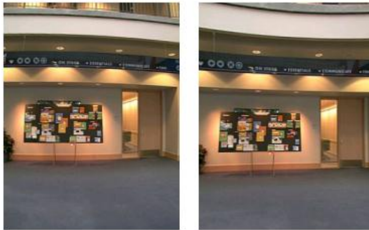
Figura 2.13 Efecto 'barrel' (izq) y 'pincushion' (der) (Szeliski, 2010).
