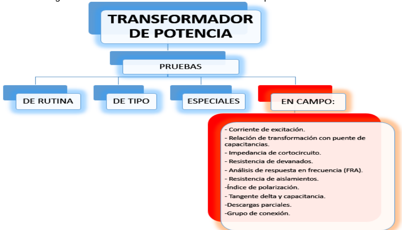
Figura 1. Pruebas realizadas a transformadores de potencia.
