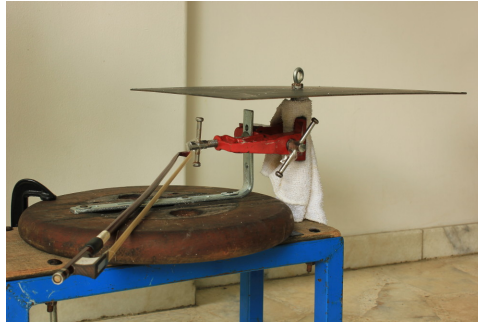
Figura 2.5.1: Montaje experimental: se sujeta la placa desde su centro por medio de un tornillo, el cual a su vez se sujeta a una base utilizando una prensa.
