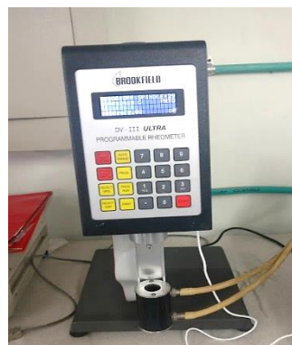
Figura .Viscosímetro Brookfield utilizado para la determinación de la viscosidad aparente del MB.
