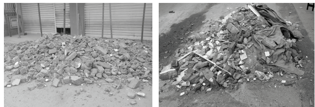
Figura 2. Residuo de mampostería obtenido de RCD de casas remodeladas. Fuente: Los Autores.
