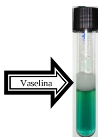
Figura 7. Tubo de prueba para oxido-fermentación con tapón de vaselina.
