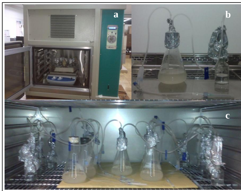
Figura 9. Montaje de fermentación. Inóculo (a), montaje fase reproductiva y fermentativa (b), disposición para toma muestra de fermentación (c).
