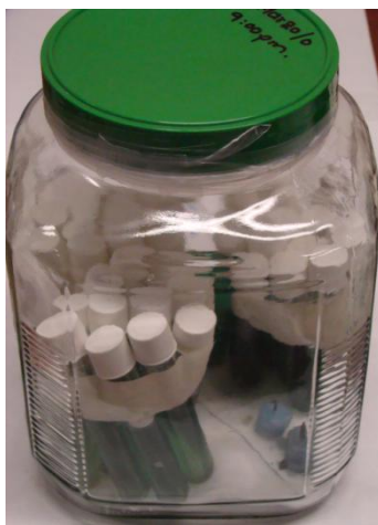
Figura 8. Frasco para crear ambiente de anaerobiosis.
