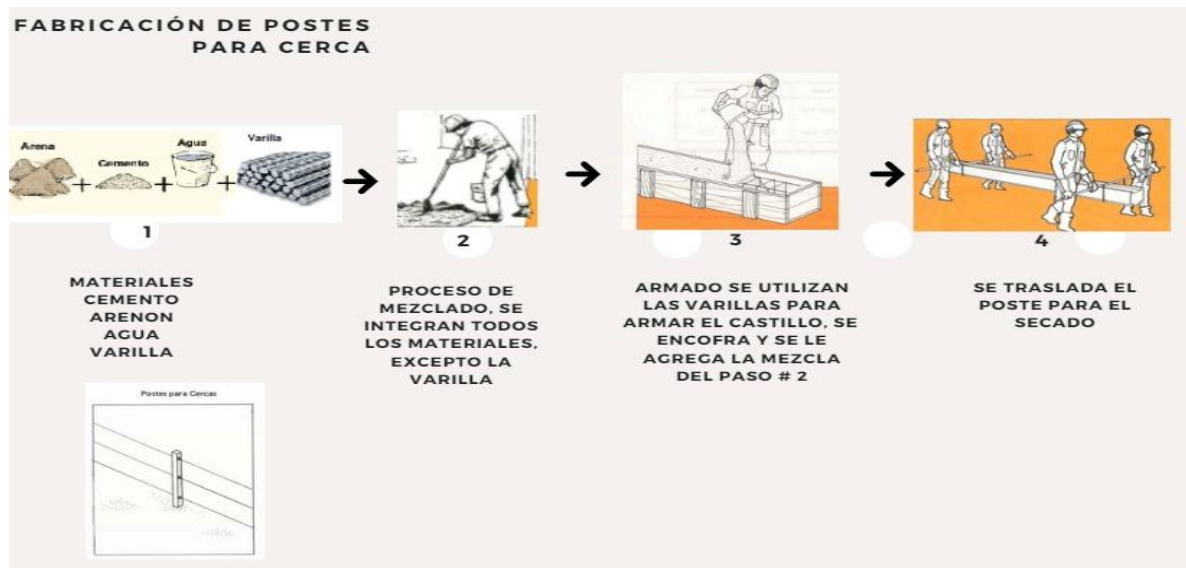
Figura No. 6 Proceso Fabricación de Postes para Cerca – Fuente elaboración propia
