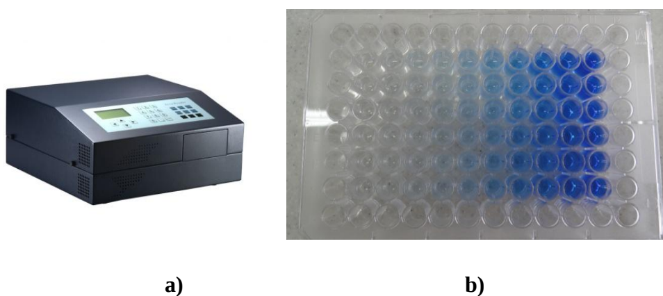
Figura 5. a) Lector de microplacas b) Microplaca con curva de calibración realizada con estándares de 1,1,3,3 TMOP
