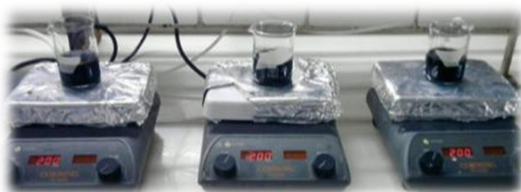
Figura 2.16 Montaje experimental de activación química
