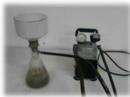
Figura 2.4 Montaje para filtración al vacío
