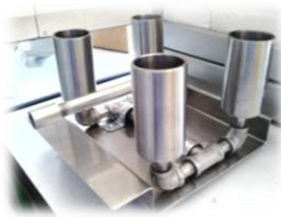
Figura 2.11 Sistema de reactores para la Producción de Carbón Activado.
