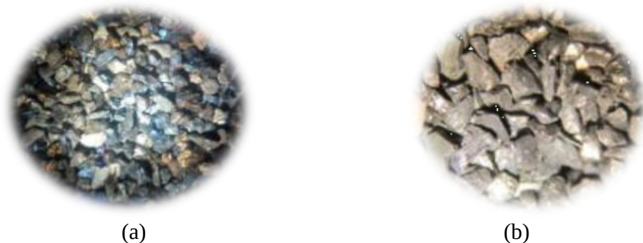
Figura 3.5 Aspecto físico en carbón del Cerrejón activado químicamente. (a) Inmediato a la activación, (b) Transcurridos 1 semana después de la activación.
