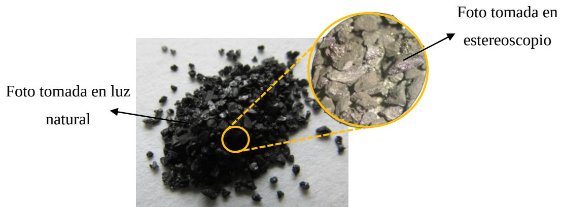
Figura 3.4 Carbón activado Valle después de molienda.
