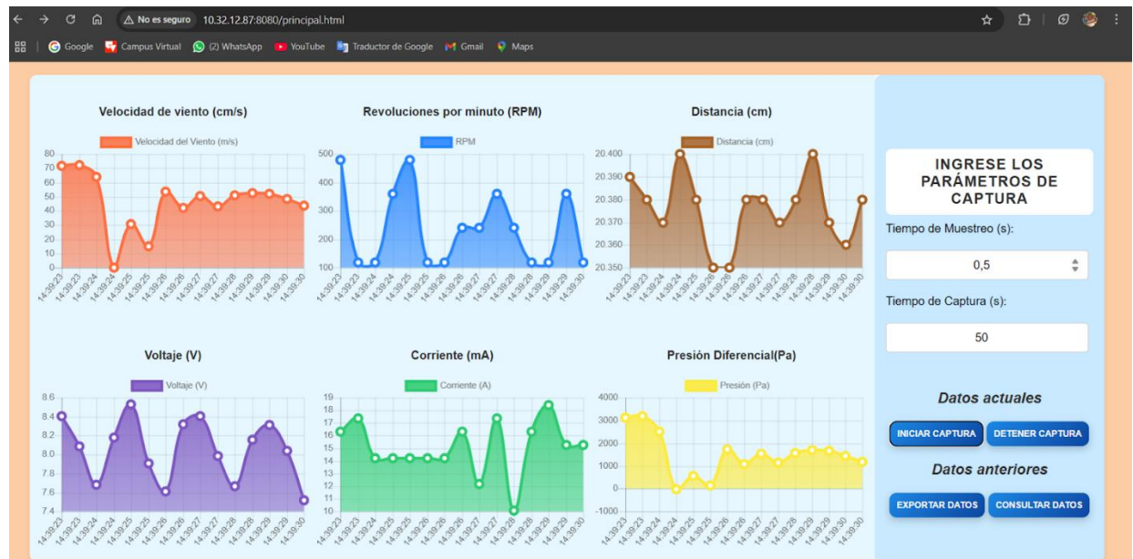
Figura 61. Captura de datos con los sensores implementados en el prototipo experimental.
