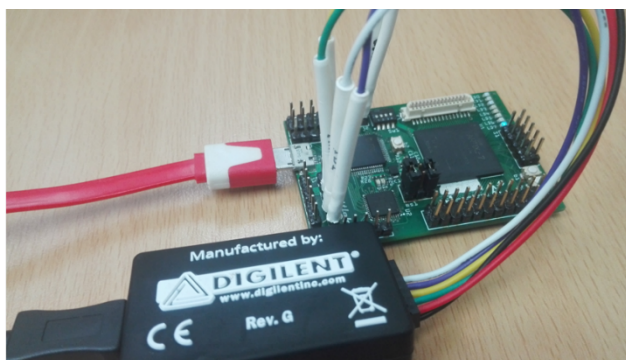
Figura 10. Conexión de Tarjeta con el software de desarrollo
