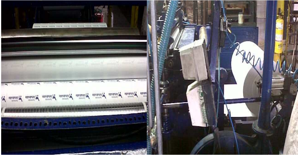
Foto 1. Conversión de rollo materia prima a rollo sumadora. Fuente la empresa.
