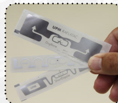
Imagen 37, Tag RFID UHF, abarca una distancia de lectura de hasta 2 metros. Recuperado de: http://rfidtiming.com/wp-content/uploads/2011/11/RFID-Tags.jpg
