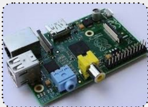
Imagen 35, Tarjeta de programación The Raspberry Pi medidas: 85.60mm x 56mm x 21mm.
