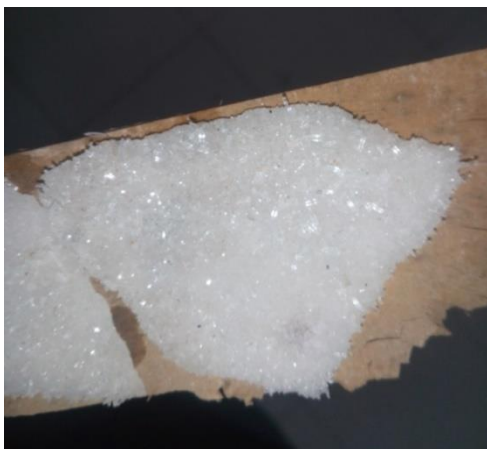
Fotografía 2. Materia prima sólida presente en los tanques de recolección de destilado líquido de la fabricación de resinas
