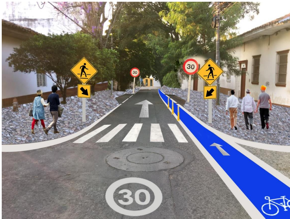
Ilustración 26. Implementación de cebra peatonal en la intersección de la Carrera 36 con Calle 4B. Fuente: Elaboración propia.
