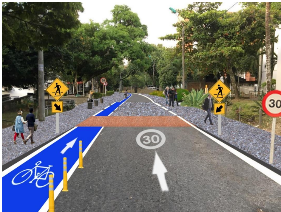
Ilustración 22. Intersección con paso elevado sobre el tramo 2.
