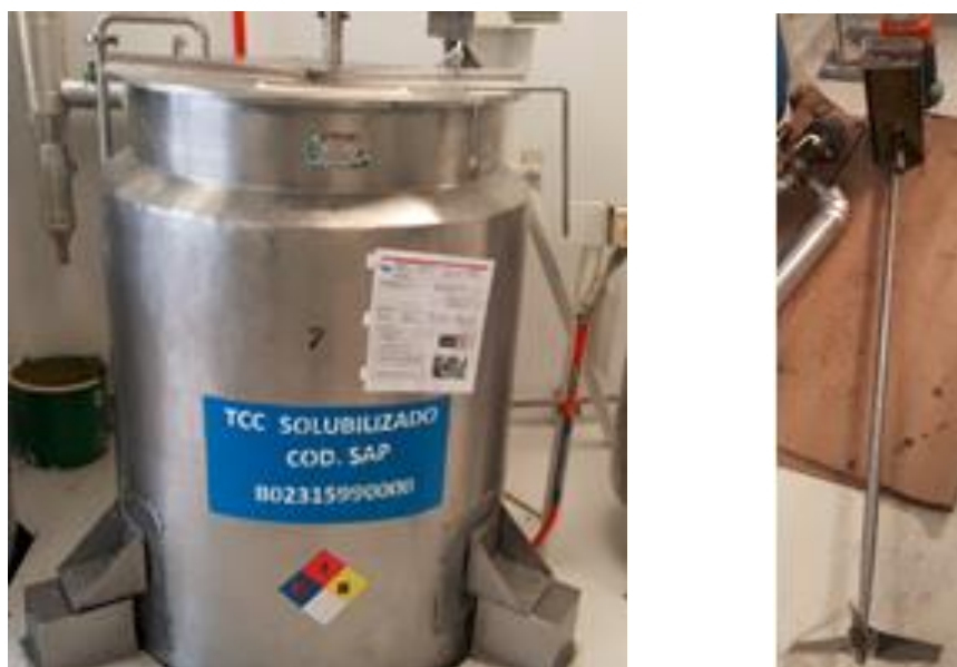
FIGURA 2 – TANQUE DE FABRICACIÓN DE MEZCLA PEG-TCC
