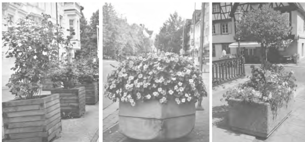
Las fotos muestran ejemplos de materas (de izquierda a derecha: Hamburgo, Gütersloh en Alemania, y de Estrasburgo en Francia) con las cuales se podría separar peatones y ciclistas en su carril de los vehículos motorizados en el otro.
