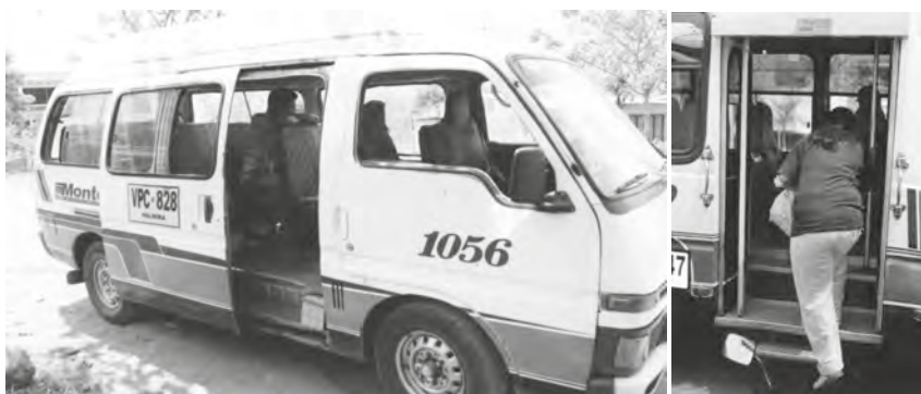
Muchos de los vehículos del TPC son incómodos; las gradas altas dificultan o impiden el acceso a la buseta creando exclusión social a una parte significativa de la población.
