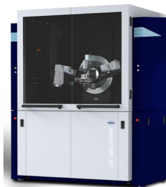
Figura 19. (a) Esquema de difracción de dos ondas de rayos X al incidir sobre dos planos atómicos. (b) Fotografía del difractómetro de rayos X Bruker D8 DISCOVER.
