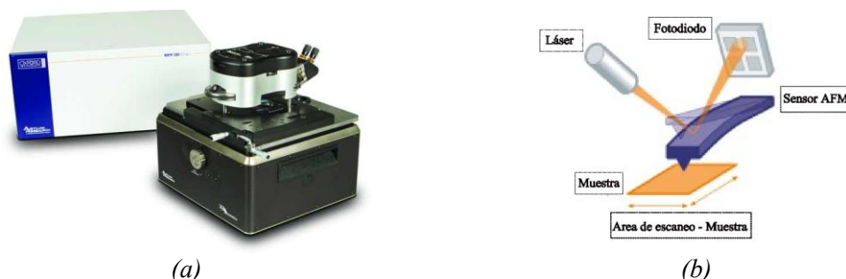
Figura 16. a) Fotografía del sistema AFM empleado en el Centro de Investigación y Desarrollo del SENA–SENNOVA (Cali). (b) Esquema del principio de operación (esquema adaptado de Oxford Instruments [60])
