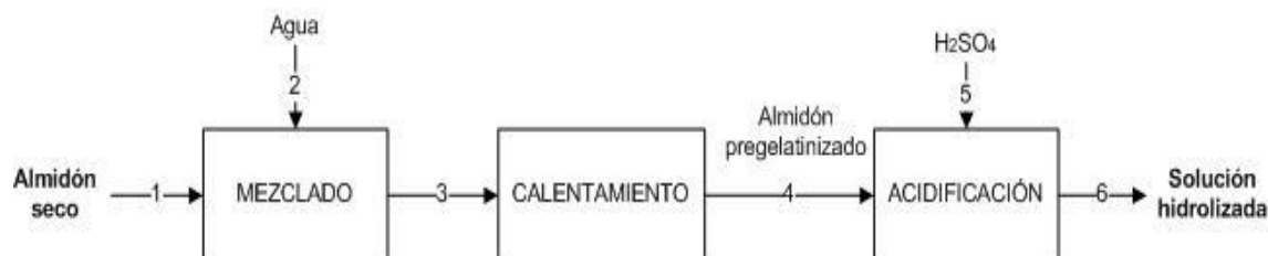
Figura 2. Diagrama de bloques para hidrólisis ácida de almidón de batata.
