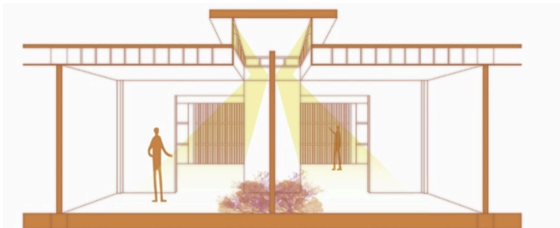
Esquema 27. Esquema de iluminación natural vacíos. elaboración propia.
