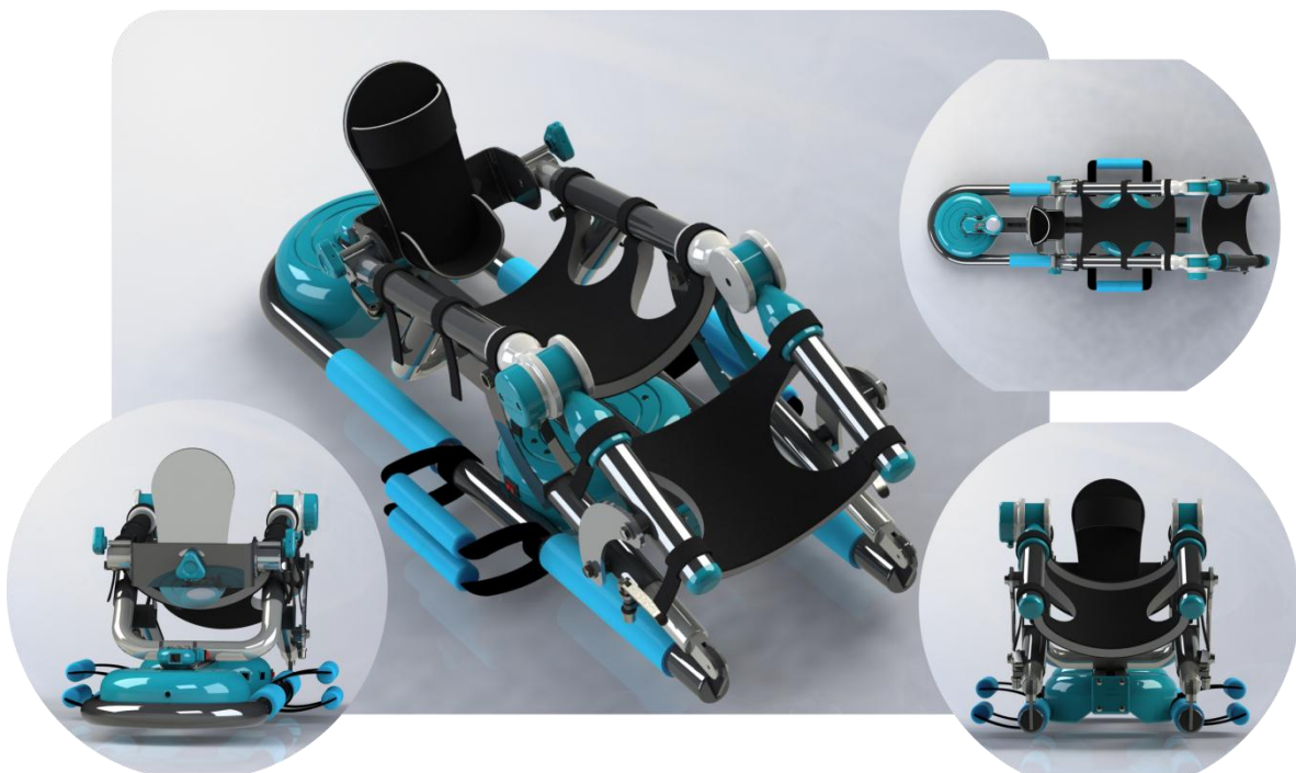
Figura 16. PCA-1 UNIDAD DE MOVIMIENTO PASIVO CONTINUO DESDE DISTINTAS VISTAS. Fuente: Autor.
