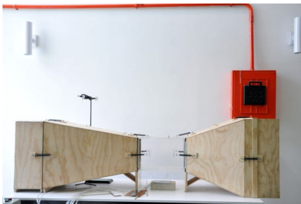
ILUSTRACIÓN 12. TÚNEL DE VIENTO U. NACIONAL DE COLOMBIA [TOMADO DE
