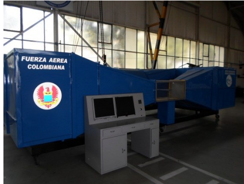
ILUSTRACIÓN 15. TÚNEL DE VIENTO DEL EMAVI [PROPIA]
