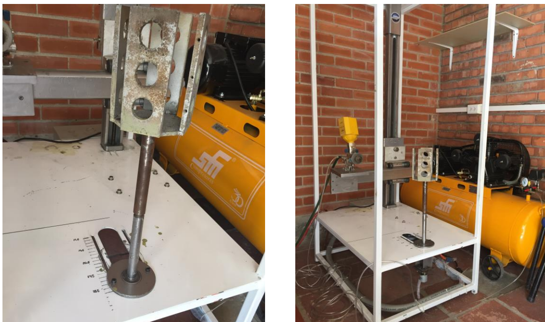
Figura 2, Portasustrato, medición de distancia de proyección y montaje del Equipo therodyn 2000, thermal spray.
