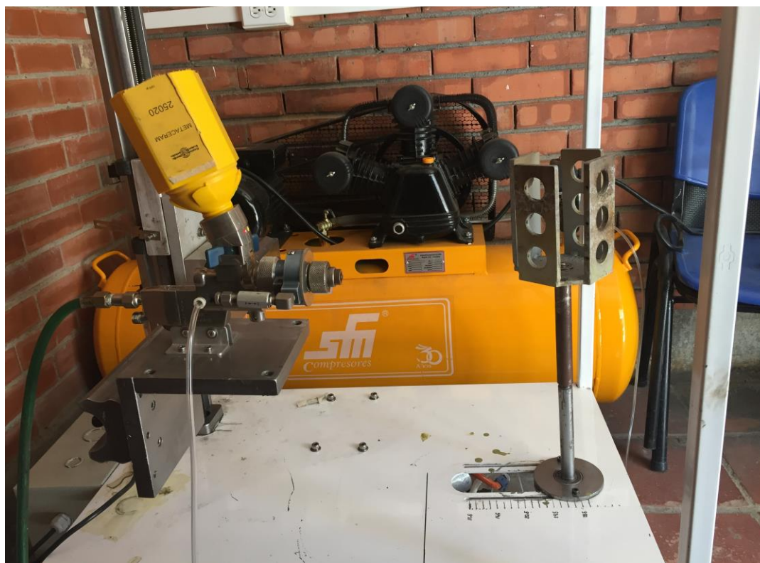
Figura 3, Montaje y adecuación Equipo therodyn 2000, thermal spray.
